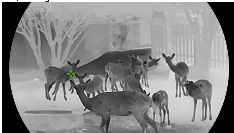
Abbildung 5-2 Stelle mit höchster Temperatur verfolgen
